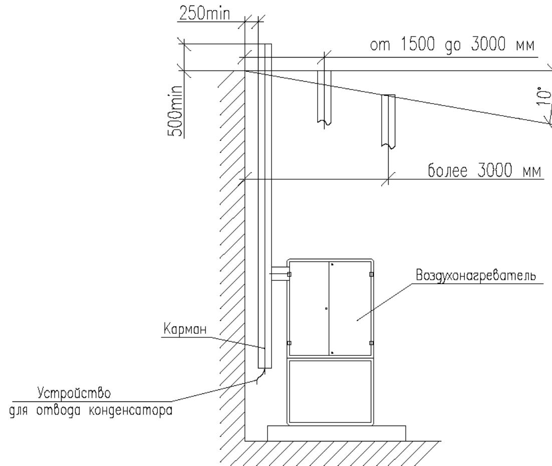
Рисунок 4 - Схема установки дымовой трубы
